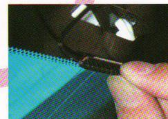
5 フィルムアンテナの端子にコネクターを取り付けます
