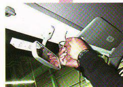
6 アースはサンバイザーのナットに共締めするか、タッピングをして取ります
