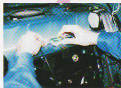
7 アンテナ出力コード、電源コードをアンプに差し込みます
