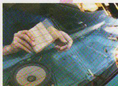
2 ガラスに薄めた中性洗剤(濃度1~2%)をかけて、フィルムアンテナを貼り付けます
