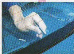
3 フィルムアンテナにコネクターを取り付けます
