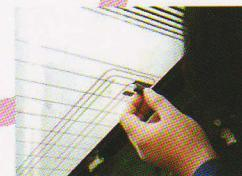
5 フィルムアンテナの端子にコネクターを取り付けます
