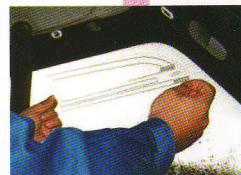
3 フィルムアンテナのセパレーターを剥がしリアクォーターガラスにフィルムアンテナを貼り付けます
