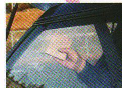
4 スqueegeeを使用しフィルムアンテナとガラスの間に気泡が残らないように取り付け充分に乾燥させます
