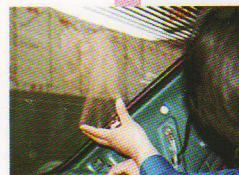
3 フィルムアンテナのセパレーターを剥がしリアガラスにフィルムアンテナを貼り付けます
